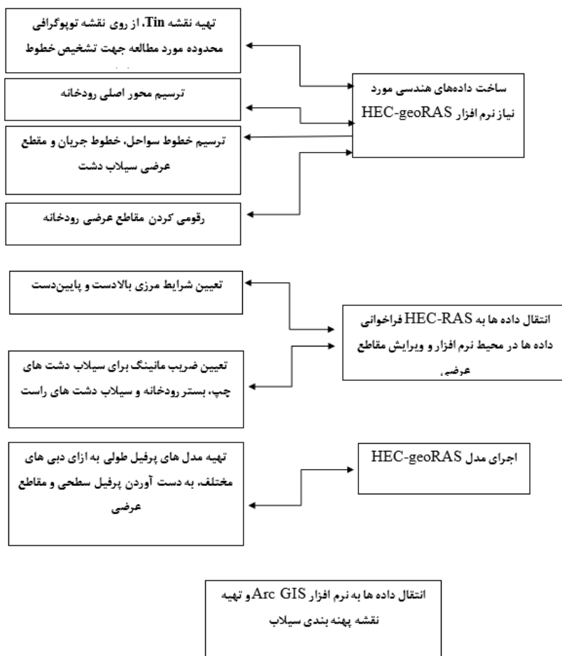
شکل ۱-شکل شماتیک از نحوه اجرای مدل HEC-RAS
